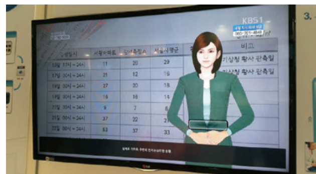
(d) PC software output overlaid on a TV screen using a chroma keyer
